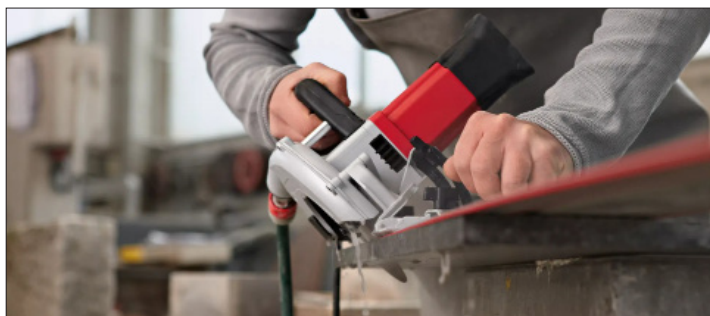
Stufenlose Winkeleinstellung für Gehrungsschnitte von 0-45°
