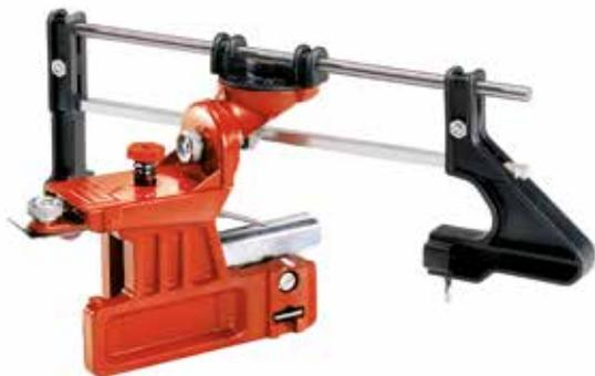
Das Feilgerät wird auf die Schiene geklemmt und die Rundfeile wird in eine bewegliche Führung eingespannt. Winkel und Eindringtiefe der Rundfeile werden am Gerät eingestellt. Auch Ungeübte können so Sägeketten einfach und richtig schärfen.
