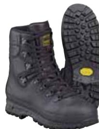
Schnitenschutzstiefel mit Gore-Tex-Innenausstattung. Memory-Foam-System (MFS): Schaumpolster des Schafts passt sich der Fußform optimal an. Ganzblattschnitt ohne seitliche Naht. 2,8 mm starkes Waterproof-Oberleder. 6 mm tiefe, griffige Sohle mit PU-Weichtrittkeilen. Schafthöhe 21 cm. Gewicht 2200 g. FPA-geprüft gemäß EN ISO 20345, Klasse I, S2 und EN ISO 17249, Schnitenschutzklasse 1.
