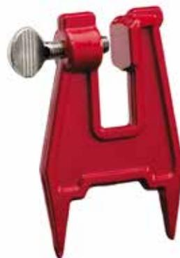
Feilbock zum Einspannen der Sägeschiene. Der Feilbock wird in einen Stamm eingeschlagen und fixiert die Motorsäge zum Schärfen der Sägekette.
