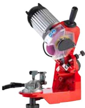
Das bewährte Schärfgerät DOLMAR340 mit 230 V-Motor, 214 Watt, 2.800 min<sup>-1</sup> und 145 mm-Schleifscheiben. Für professionelles und präzises, gleichmäßiges Schärfen von Sägeketten. Inkl. eingebauter Beleuchtung für den Arbeitsbereich.
