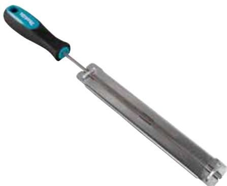
Die Rundfeile wird in ein Führungsblech eingespannt und mit einer Strichmarkierung parallel zur Schiene durch den Hobelzahn geführt. Die Eindringtiefe der Feile regelt das Führungsblech. Mit ein wenig Übung werden perfekte Schärfungen erzielt.
