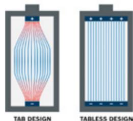
Niedrigerer Innenwiderstand führt zu weniger Wärmeentwicklung, wodurch sich die Laufzeit von Akkus mit Tabless-Zellen erhöht
